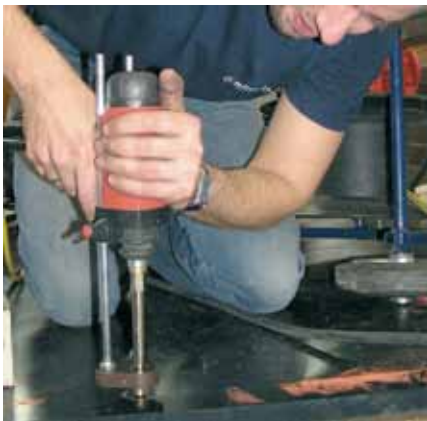
Надежное крепление: шпилька с резьбой приваривается к основанию через предварительно просверленную плиту
