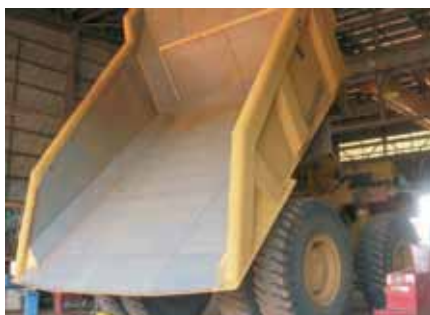
Карьерная техника: футерованный листами Matrox® X кузов самосвала для перевозки руды в Австралии
