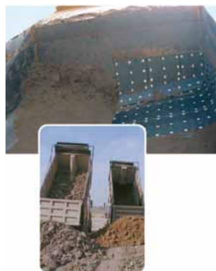
Сравнение Matrox® со сталью: в то время как сыпучий материал на не обшитых стальных листах остается налипшим большими слоями, то с поверхностей, футерованных плитами Matrox®, он почти полностью удаляется
