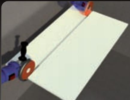
Плиты толщиной 3см необходимо распиливать в два этапа, как это указано на диаграмме. Сначала плита прорезается на половину толщины, а затем вторым пропилом прорезается на всю толщину.
