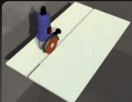
Отрезной диск должен быть идеально расположен по направлению реза.
